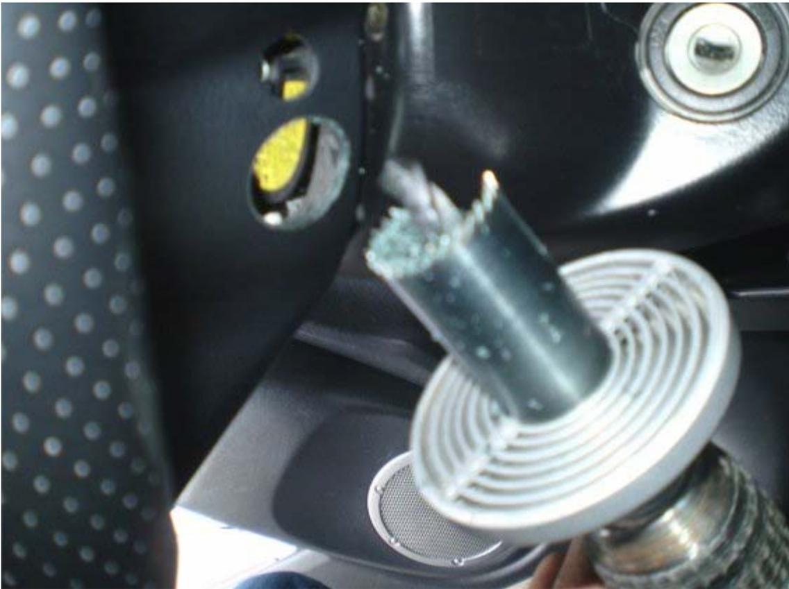
il risultato è questo, un foro perfettamente rotondo ma ancora con delle leggere sbavature di plastica:
