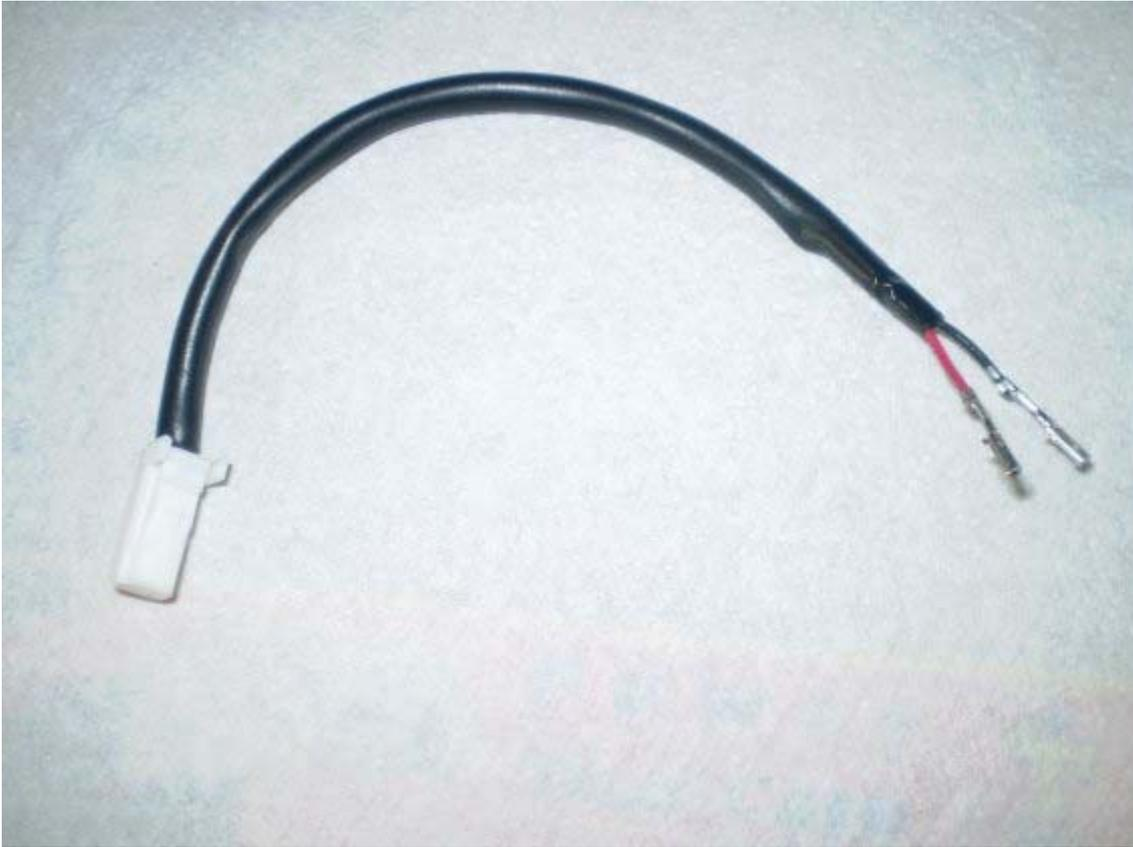
i due poli vanno inseriti bene a fondo nello spinotto (dopo averlo staccato dal connettore audio) già presente nel volante nel modo e nel colore indicato dalle frecce:
